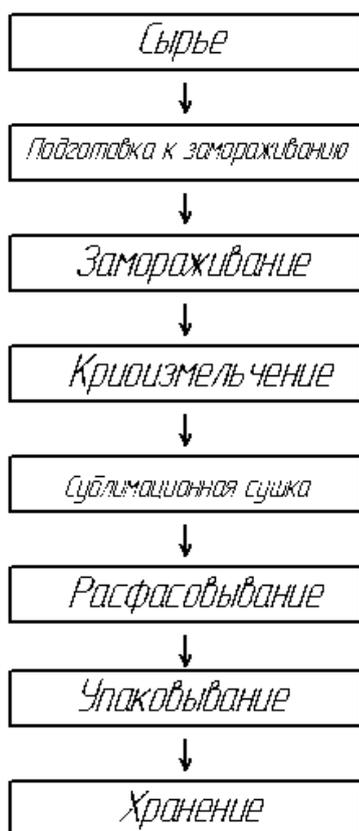
Рис. 1. Криотехнология обработки голотурий
